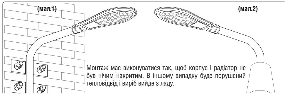
Монтаж має виконуватися так, щоб корпус і радіатор не був нічим накритим. В іншому випадку буде порушений тепловідвід і виріб вийде з ладу.
